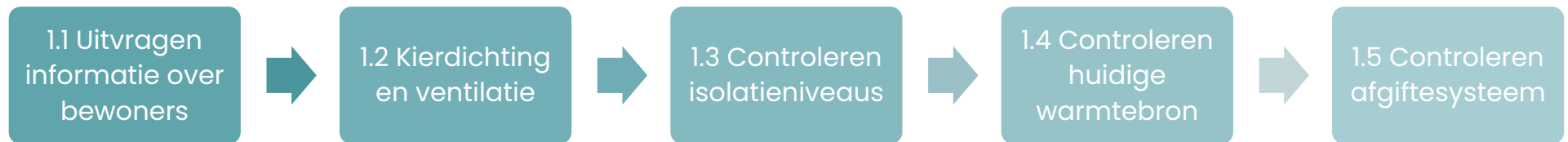
Figuur 13 – Werkwijze voorbereiding woning op een warmtepomp.
